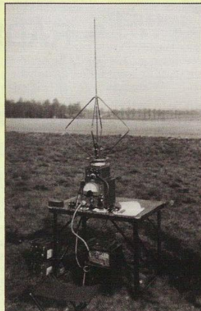
Obr. 5. Menší zaměřovací přijímač od firmy Kapsch, typ R30 (Fu. N. P. Ger. a/c) s rozsahem 0,192 – 25 MHz pro zaměřování a 0,081 – 25 MHz pro odposlech, určený spíše do osobních vozů
