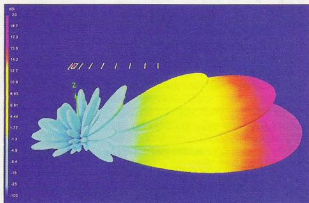
Obr. 15. Trojrozměrný vyzařovací diagram dlouhé devítiprvkové antény pro 50,150 MHz
