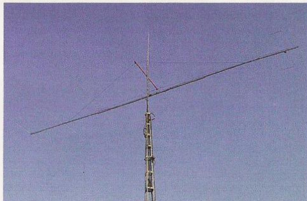
Obr. 14. Devítiprvková Yagi LFA pro pásmo 50 MHz (konstruktér José Ramon, EA7KW, Sevilla)
