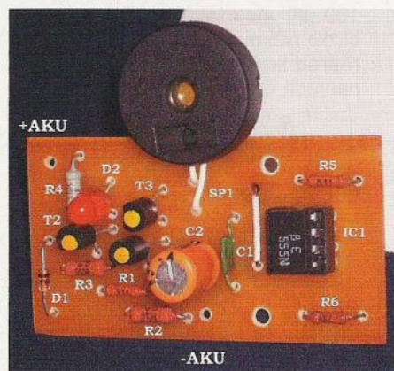
Obr. 4. Deska se součástkami původní verze hlídače akumulátoru 12 V
