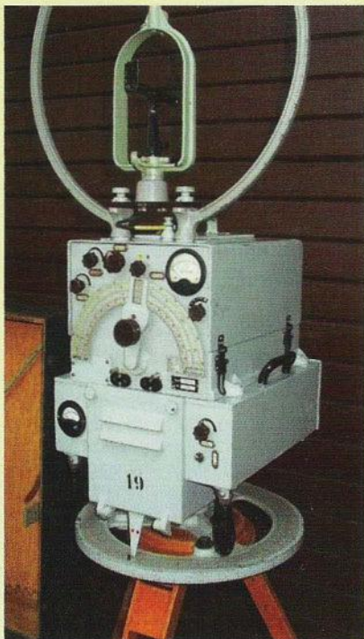
Obr. 4. Zaměřovací přijímač P 57 N (3 – 20 MHz), určený hlavně pro dodávky
